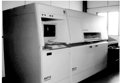
Рис. 6. 3D-принтер, использующий SLS-технологию — устройство компании RapidForm
